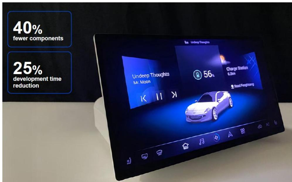
マレリのスケーラブルで最適化されたバックライト技術により、LED 数は従来の 256 個から 48 個に削減。独自開発のレンズによって光の均一な分布も達成し、性能を損なうことはありません。
