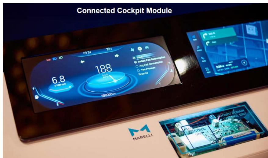
非統合型ソリューションと比較すると、LeanConnect はコストを 30% 削減し、開発期間も 25% 短縮可能です。配線ハーネスの接続ポイントが減ることでサイクル・タイムも短縮され、環境負荷の低減にも貢献します。具体的には、消費電力約 10 ワット削減、ECU 数・CAN ライン・コネクタの削減、システム重量約 1.2kg 減、サプライチェーンの簡素化などが実現できます。
