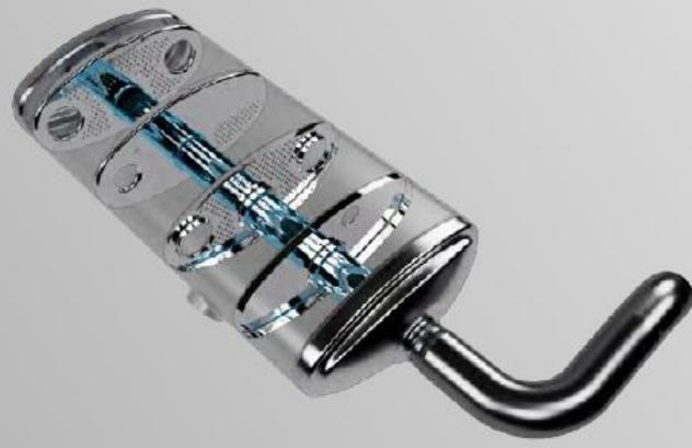
この構造により、マフラー内部で空気粒子の振動を促進し、排気ガスのエネルギーを熱エネルギーに変換することで、排気音を効果的に抑制します。
