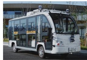
タジマモーターコーポレーション社製「GSM8」を自動運転仕様で改造したモビリティ。世界20か国以上で活用実績のあるオープンソース自動運転ソフトウェアである「Autware」を搭載。
