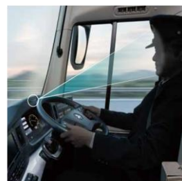
白線認識カメラ・顔認識カメラを搭載 ⇒注意力の低下を警告
