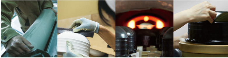
成形した本土鍋は、四度の焼き工程を経て完成します。
