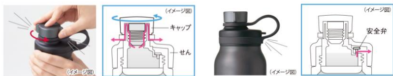
ゆっくりせんのキャップを回すと炭酸ガスが抜ける「炭酸ガス抜き機構」で吹きこぼれを防ぎます。
