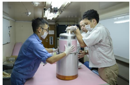
小型回収カプセル（HSRC）で回収されたペイロード 収納容器から真空二重断熱容器（魔法瓶構造）を取り 出す様子 （写真：JAXA提供）
