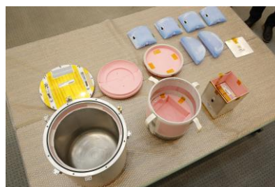
小型回収カプセル (HSRC) に関する記者会見で公開されたペイロード収納容器や真空二重断熱容器 (魔法瓶構造) 等
