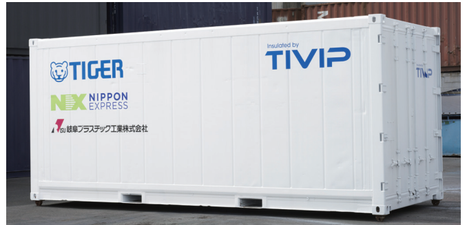
ステンレス密封真空断熱パネルを使用した真空断熱リーファーコンテナ
