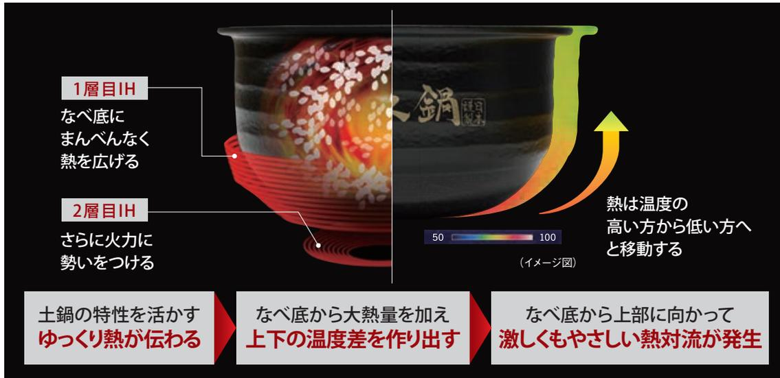
自然由来の土鍋の蓄熱性は高く、金属鍋より格段に高い温度でお米に熱を加えることが可能です。タイガー最上位モデル炊飯器JRX型では、土鍋の蓄熱性と新搭載「300℃ WレイヤーIH※2」構造を用いることで、タイガー史上最高温度である約300度※3まで炊飯時の温度を高めることに成功しました。
