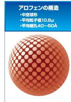
※図1 アロフェンの構造イメージ図
