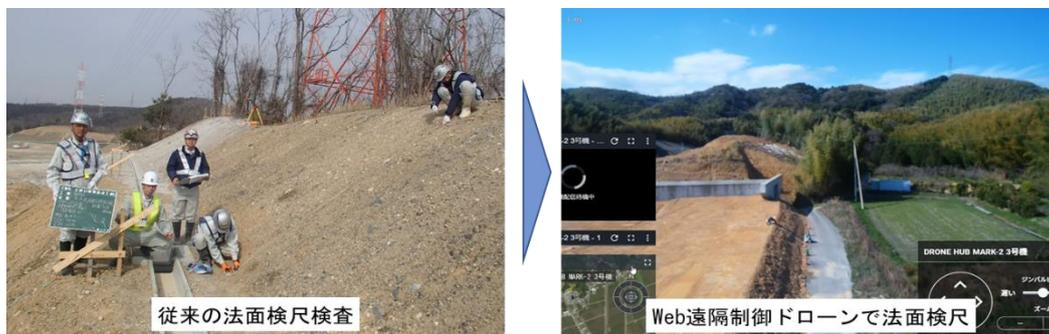
写真1 Web 遠隔制御ドローン運用状況
