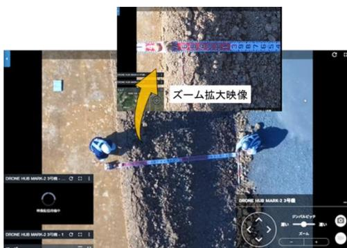
写真2 遠隔臨場で法長検尺
