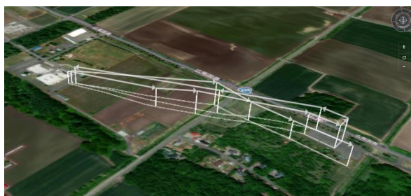
設定した飛行ルートに合わせてドローンが自動飛行
