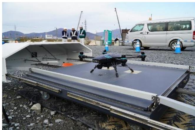
フジタでは、最新のドローン測量やIoT重機土工の『全工程見える化』を推進しており、その一環として、現場での安全巡視・設備点検を省人化するシステム『SENSYN DRONE HUB』を活用した実証実験に取り組んでいます。
