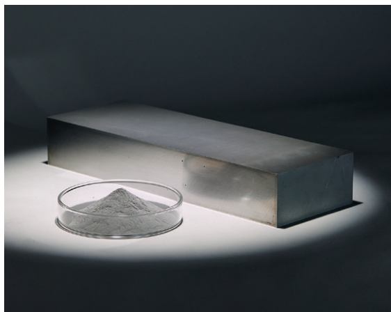
粉末耐食耐摩耗合金の粉末とスライス前の金属ブロック
