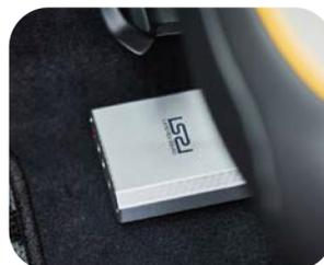
専用アンプは軽量でコンパクト。助手席の下に設置されます。
