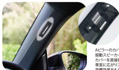
Aピラーのカバー内部に新技術の振動スピーカーを装着。カバーを直接振動させて生まれる反響音は車室に広がりコンサートホールのような音響効果をもたらします。
