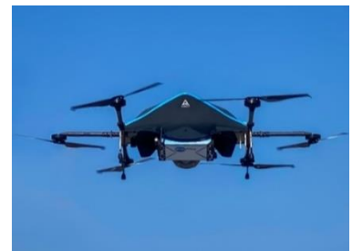
実証実験に使用された日本発物流専用ドローン“AirTruck”
