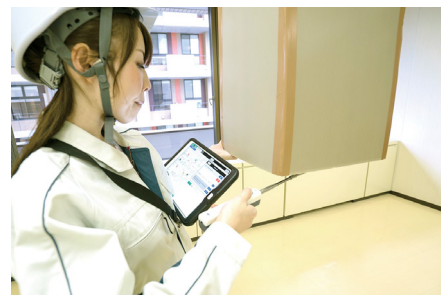
フードを使用した風量測定風景
