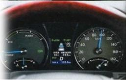
上/ACCは、レーダーを照射するなどして、前の車との距離を測り、車間を自動調整する(写真はイメージ)。中/ACCのコントロールスイッチは、ハンドル周りに装着されていることが多い。下/前車との車間は3段階に調整できるのが一般的。写真は2段階目に設定。
