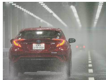
雨量 80mm/h（昼間）の豪雨テストイメージ テスト車（赤）から見た前方の停止車両（テールランプ点灯）
