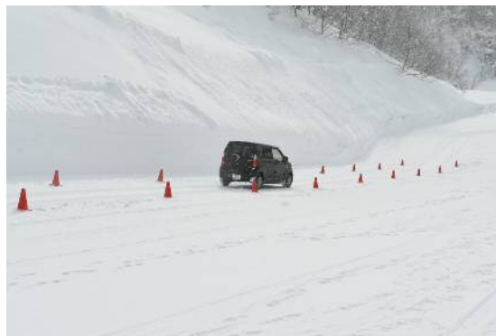
平坦路（左写真）と下り坂（右写真）でブレーキ性能を検証
