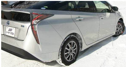
今回のテスト車の場合、前輪（駆動輪）に装着が正しい状態（写真左）、後輪（非駆動輪）に装着は誤った状態（写真右）
