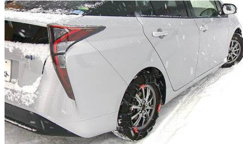
今回のテスト車の場合、前輪（駆動輪）に装着が正しい状態（写真左）、後輪（非駆動輪）に装着は誤った状態（写真右）
