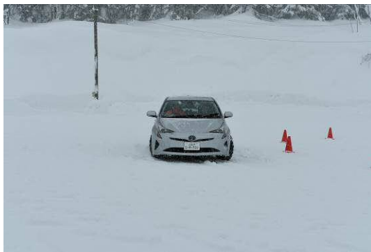
チェーンの装着位置の違いで旋回性能を検証
