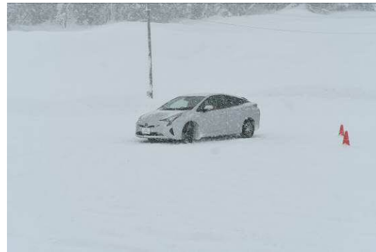
チェーンの装着位置の違いで旋回性能を検証
