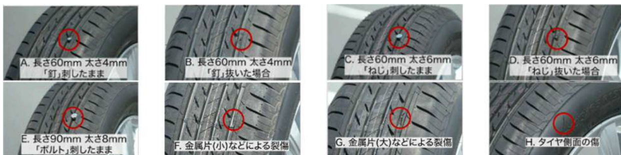
さまざまな条件でパンクした状態の8種類タイヤで比較
