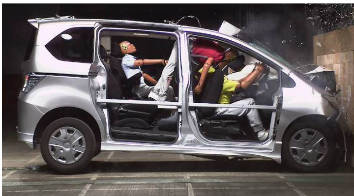
シートベルト非着用の後席ダミーがシートごと運転席ダミーを押しつぶした ※後席ダミーは運転席側でシートベルト非着用、助手席側でシートベルト着用
