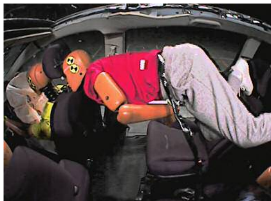
シートベルト非着用の後席ダミーがシートごと運転席ダミーを押しつぶした ※後席ダミーは運転席側でシートベルト非着用、助手席側でシートベルト着用
