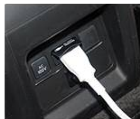
EV、PHV、HVに装備されているACコンセント（イメージ）
