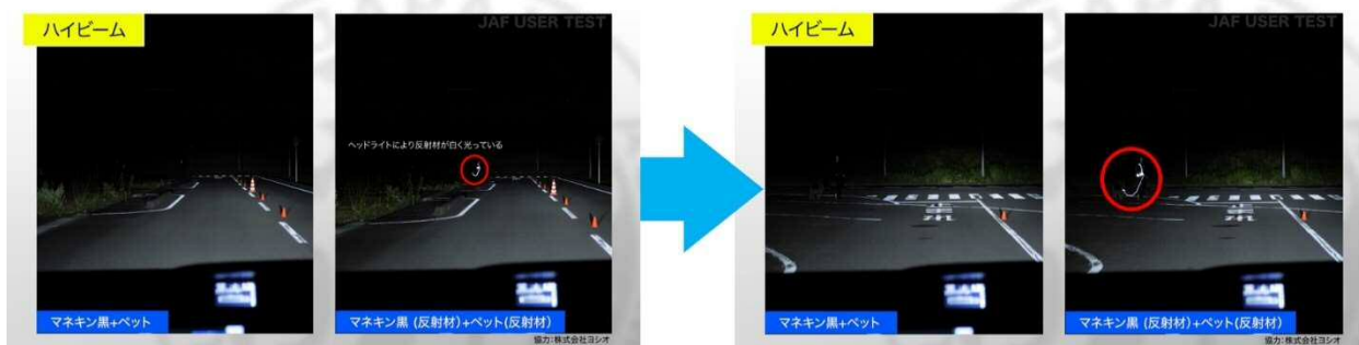
ハイビームでの比較映像。反射材を着用していると遠くからでも発見できるが、非着用だと進行方向が暗くて人と犬は見えない。
