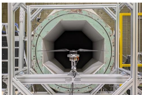
自社研究開発の例「東北大学プロペラ風洞試験」の様子
