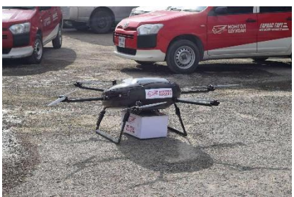
郵便物を載せた専用箱を切り離し置き配するドローン
