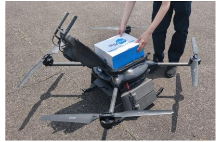
物流ドローン「PD4B-M LogiAir」 荷物の取り付けの様子
