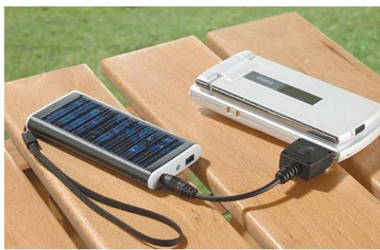
太陽の光で充電できるモバイル充電器です。蓄電タイプのため、充電したエネルギーは貯めることができます（約10～15時間のソーラー充電で携帯は2～3時間稼動可）。ドコモ・au・ソフトバンク、3種のコネクターとUSBケーブルが付属。
