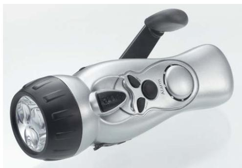
LED懐中電灯（LEDライトは1灯及び3灯の2パターン）、FMラジオ、携帯電話充電、サイレンが1つになった多機能アイテムです。電池不要の手回し式充電であるため、いざという時に役立ちます。1分間（120回転）の手回しで、懐中電灯がライト1灯約20～30分、ライト3灯約8～10分、ラジオが約5分、携帯電話通話が約1分です。
