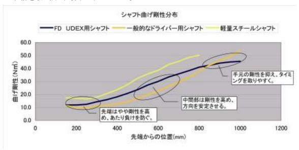
FD-UDEX 専用 ELASTER は、一般的なドライバーと軽量スチールシャフトの中間の剛性分布。手元の剛性を抑え中間部の剛性を高めることにより、タイミングがとりやすく方向性が安定します。中間部から先端部にかけては、剛性の勾配を大きくすることでヘッドが走り、飛距離を伸ばします。また、シャフト内部にゴム素材スピードラバーを複合することで、しなり戻りが高速化し、ヘッドスピードが約 0.9m/s アップします。
