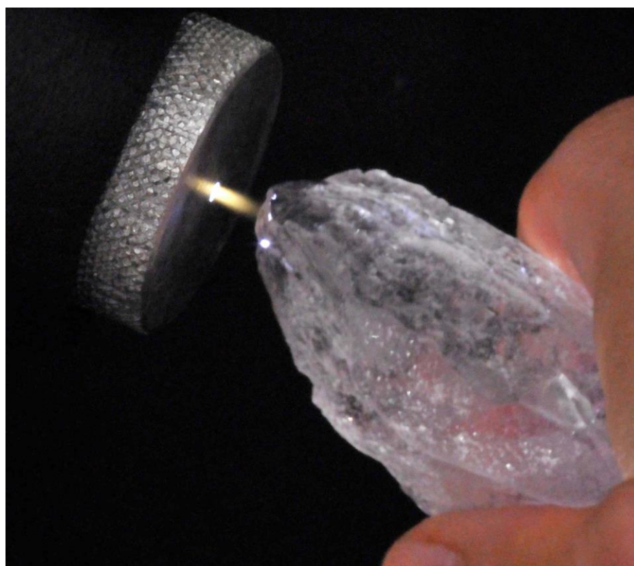
図2 低温に制御した大気圧プラズマを氷に照射
