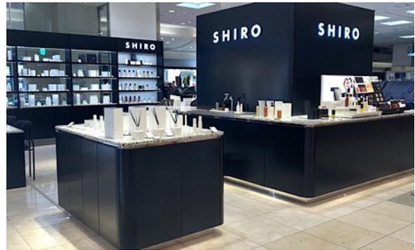
リニューアルを機に改めて既存の什器などの状態を見てみると、什器側面のネイビー塗装の下地がステンレスであることが分かりました。ベージュカラーのお店に合うデザインを考え、側面に再度塗装を重ねるのではなく、既存の塗装を剥がしてステンレスというマテリアルそのものの良さを活かすことに。表層を剥がして露出したステンレスは光の反射が少ないパイブレーション仕上げが施されており、テラゾータイルや左官材との絶妙なバランスを生み出しました。
