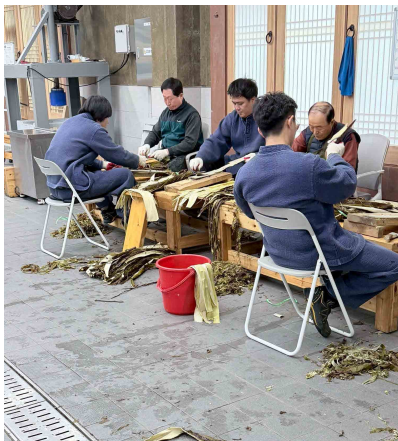
(左・中央)楮の枝を柔らかく蒸し上げ、冷めないうちに手作業で、丁寧に外皮を剥ぎます。真冬の寒い時期に行われることが多く、指先の力と根気が必要な作業。(右)晋州(チンジュ)の工房にて、韓紙を植物染料にて染めている様子
