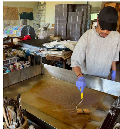
(左・中央)楮の枝を柔らかく蒸し上げ、冷めないうちに手作業で、丁寧に外皮を剥ぎます。真冬の寒い時期に行われることが多く、指先の力と根気が必要な作業。(右)晋州(チンジュ)の工房にて、韓紙を植物染料にて染めている様子
