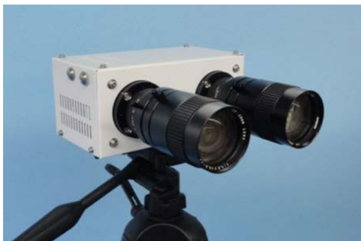
本ソリューションで使用する光子無線通信送受信端末機器
