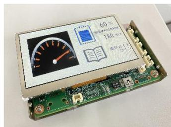
液晶ディスプレイ単体での提供だけでなく、タッチパネルや制御回路基板を組み込んだディスプレイユニットをワンストップで提供します。制御回路基板は、コマンド制御型・映像入力型の2タイプを開発中です。
