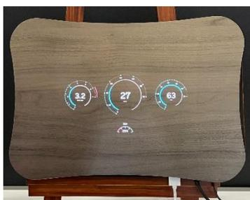
本展示会に出展する加飾ディスプレイは、2024年4月にリリースした透過性の高い化粧シート「ダブルビュー®フィルム」(※2) に、ローカルディミングバックライト(※3)を採用した「Blanview™ (ブランビュー)」液晶を組み合わせた。これにより加飾ディスプレイの表示部と加飾部の境目が黒浮きして見える現象の発生を抑え、背面から浮かび上がるような表示を実現しました。加飾シートのデザインは木目調以外にも様々なデザインを用意しています。オフィスや工場内の受付操作端末や入退室管理モニターなどの用途に対して、表示機器が存在することを意識させない内装と調和したディスプレイを提供します。
