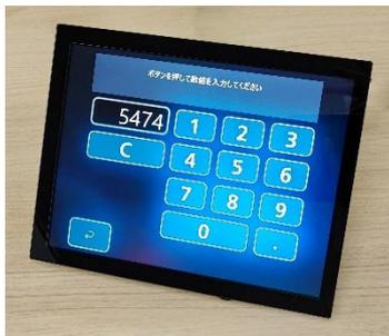
静電ホバータッチディスプレイは、TOPPAN の空中タッチディスプレイ「La+ touch™」で培った非接触タッチセンサー技術に応用した最新の入力デバイスです。静電ホバータッチディスプレイは、空中タッチディスプレイは「La+ touch™」よりもさらなる薄型要望や屋外用途の要望に対応するため、「Blanview™」液晶採用により、小型薄型・高輝度屋外視認性向上を実現しました。本展示会では、直接触らずに操作可能な静電ホバータッチディスプレイの実機展示・デモンストレーションを用意しています。
