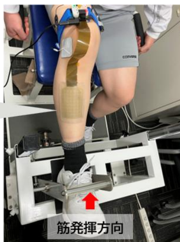
シート型ウェアラブル圧力センサ
