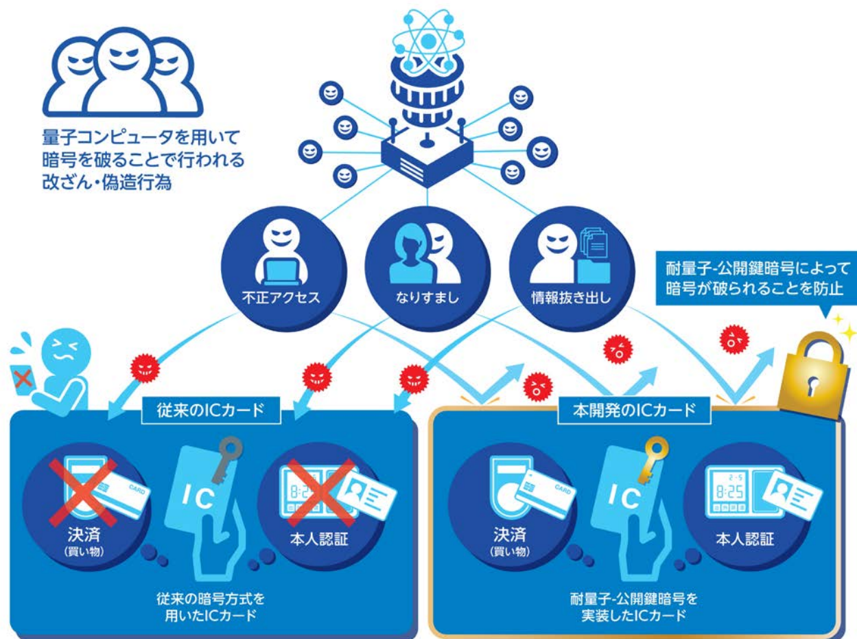
従来の IC カードと耐量子-公開鍵暗号を実装した IC カードの違い
