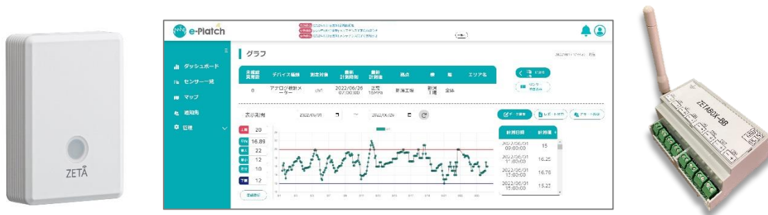
左から「ZETA 通信対応 温度・湿度・照度・CO2 濃度マルチセンサ」、 「環境データ閲覧システム」、「ZETABOX™」防爆仕様
