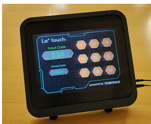
空中タッチディスプレイ「La+ touch™」12 インチモデル試作品
