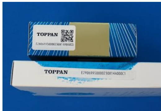
紙器パッケージの側面に IC タグを貼り付けたイメージ
