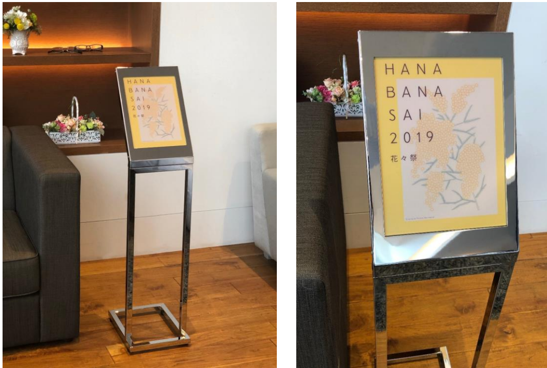
世界初のフルカラー電子ペーパーを使用したデジタル POP のプロトタイプ
