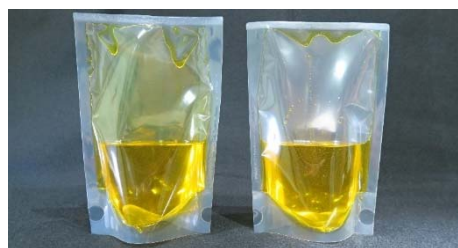
食用油を使用した比較実験では、従来品(左)と比較し、今回開発した撥液機能を有するパウチ(右)は内容物が付着しにくい
