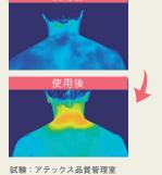
試験:アテックス品質管理室 室内温度:約20℃/湿度:約50% 約10分間使用
