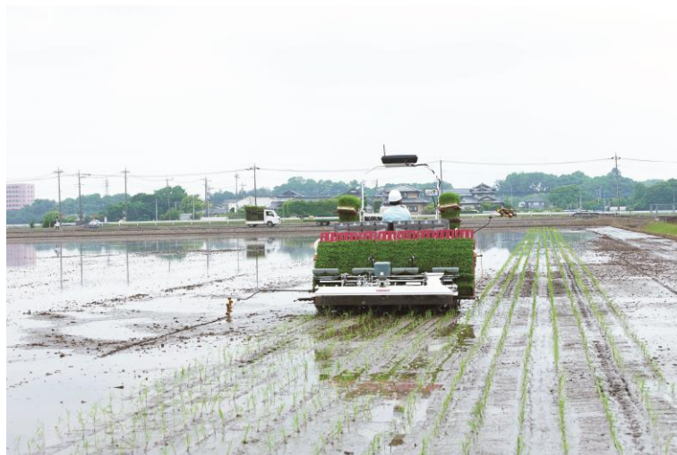
<オート田植機 YR8D,A による密苗植付作業>
