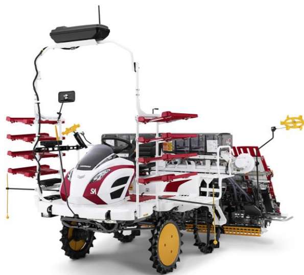
<自動運転技術を採用した 密苗田植機 オート仕様「YR8D,A」>
