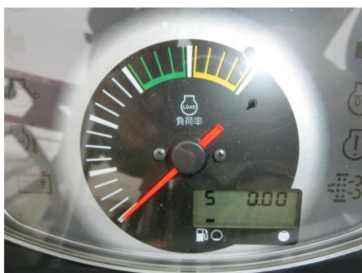
<作業速度をデジタル表示する「メーターディスプレイ」イメージ>
