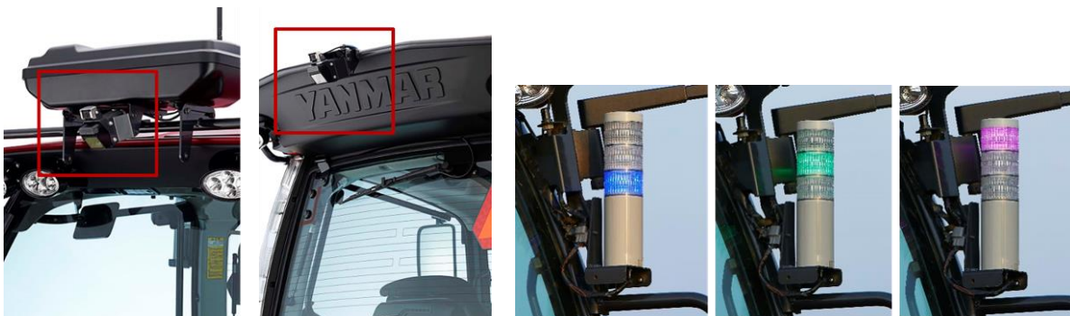
<人や障害物を検知する安全センサー（左）、3色のセーフティランプ（右）>
