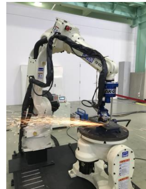
愛知産業の AK グラインダーに、3 M™ キュービトロン™ II フラップディスク 967A を装着し、溶接ビードを研磨している様子
