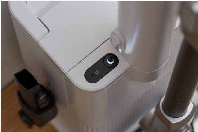
ゴミ捨て時期の目安をお知らせする 「ゴミ捨てインジケーター」(左のゴミ箱マーク)
