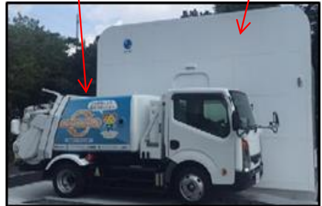
EV ごみ収集車 (手前) と 電池ステーション (奥)
