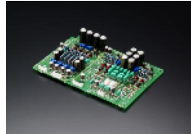
その結果、低域から高域までサウンドキャラクターが変化しない理想的なフォノイコライザーを実現しました。そして、PM-11S3に搭載される最新型では、サーボ回路をDCサーボからV/Iサーボ化することで回路をシンプル化し、再生音の純度を高めました。
