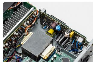
シールドにより回路間のノイズの飛び込みを抑え、電源ラインに流入するノイズはデカップリングコンデンサーを用いて除去しています。エルナー社製オーディオグレード表面実装コンデンサーを採用するなど、挿入するコンデンサーの種類や定数は、サウンドマネージャーによる試聴を繰り返しNR1609に合わせて最適なものを選定し直しました。さらには基板やシャーシを固定するビスやワッシャーの種類を使用する箇所に応じて変更しグラウンドインピーダンスを最適化するなど、これまでに積み重ねてきた様々なノウハウを用いて音質をまとめ上げています。
