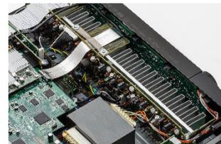
ディスクリット構成であるため、回路設計およびパーツ選定の自由度が高く、Hi-Fi アンプと同様に徹底した音質チューニングを行うことができます。
