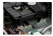
を直接グラウンドへと逃がし、周辺回路への不要な振動の伝搬を防止しています。また、もっとも大きな質量を持つパーツであるドライブ・メカニズムをシャーシ中央の低い位置に堅牢なスチールブラケットを介して固定。 ディスクの回転による内部的な振動や外部から受ける振動にも強い構造を実現しています。
