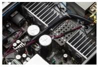
ノンは 1 ペアという最小単位の素子による増幅にこだわり続けています。さらに音質への影響の大きい入力カップリングコンデンサを用いないシンプル&ストレートな回路構成により、鮮度の高い再生を実現しています。
